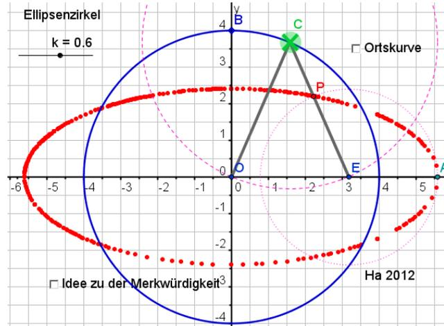
Realisiert sind zwei gleichlange Stangen. Die eine dreht sich um 0, die andere ist mit ihr in C verbunden und wird auf der x-Achse geführt. P markiert die k-fache Länge ( $k < 1$ ) dieser Stange. Der geometrische Ort von P ist eine Ellipse -- oder doch nicht?
