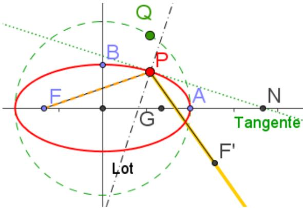
Wir wählen einen Punkt F auf der x-Achse, von dem aus ein Strahl in P reflektiert wird. G ist der bezüglich der Ellipse zu F symmetrische Punkt. I.A. verläuft der reflektierte Strahl nicht durch G.
